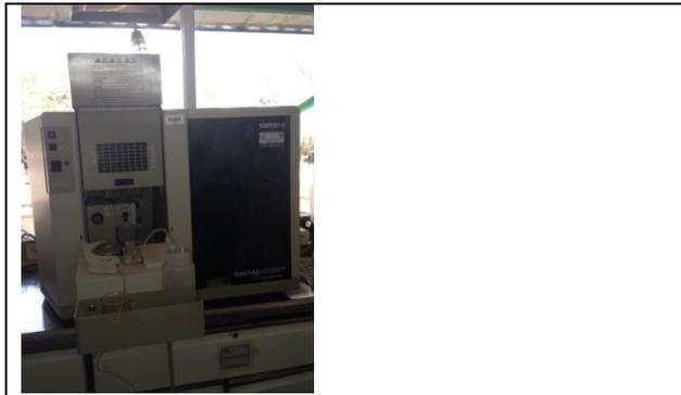
**Fotografía 9.** Espectrofotómetro de absorción atómica marca Varian, utilizado para la lectura del cadmio.
